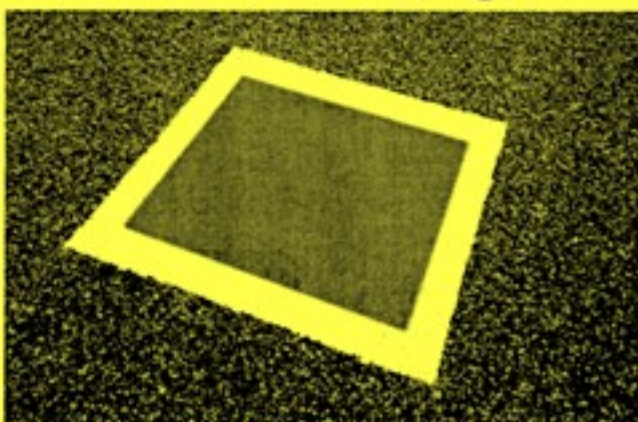
Un patch de résine thermosensible. Il vire au magenta quand la chaussée gèle. PHOTO: EUROVIA
